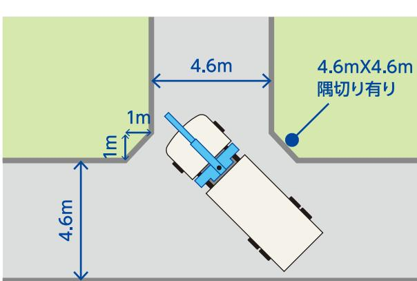
※ガードレール・電柱・壁・中央分離帯がない場合での有効幅です。
